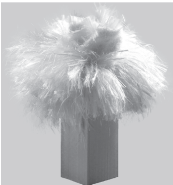
Illustration af hvor meget armering, der findes i et kompositprofil fremstillet ved produktionsmetoden pultrudering.
