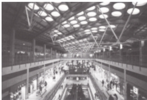
Fig. 9. Hybrid træ- og stålkonstruktion. Centre Commercial, Bercy 2, Paris. Arkitekt: Renzo Piano, 1990.
