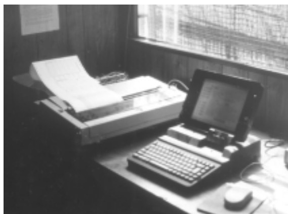
Fig. 4. For store renoveringsopgaver med realkalisering og afsaltnings af betonkonstruktioner er der mange ledninger at holde styr på. Derfor automatiserer man registrerings- og styringsarbejdet ved hjælp af en datalogger.
