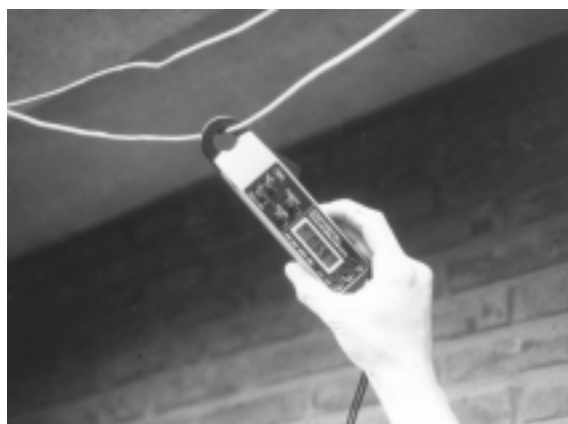
Fig. 3. Strømmen i ledninger til de enkelte kontrolafsnit følges nøje og korrigeres om nødvendigt. Manuel kontrol foretrækkes for mindre renoveringsarbejder, men ved større arbejder må kontrolarbejdet automatiseres.
