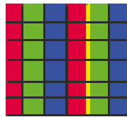
Forstørret udsnit af fjernsynsskærm.
