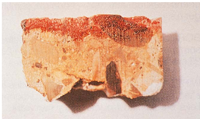
Boracols indtrængen i beton.
